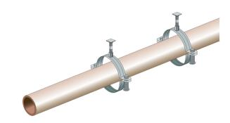
Rohr in die Schellen einlegen und positionieren ...
