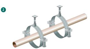
Rohr in die Schellen einlegen und positionieren ...
