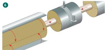
Isolierungsstücke auf das Rohr schieben und von außen mit grauer Folie ummanteln. Anschließend kompress mit dem Rohrträger verbinden ...
