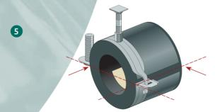
Die Naht der einseitigen IF-Rohrträgeröffnung liegt immer horizontal, unabhängig von der Position der Schellenververbindungen ...
