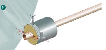
Rohrträger-Naht liegt horizontal auf gleicher Höhe wie Schellenverschraubungen ...
