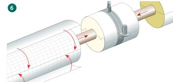
Isolierungsstücke auf das Rohr schieben und von außen mit grauer PVC-Folie ummanteln. Anschließend kompress mit dem Rohrträger verbinden ...
