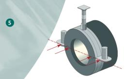
Rohrträger-Naht liegt horizontal auf gleicher Höhe wie Schellenverschraubungen ...
