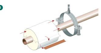
Überlappende Schutzfolie festkleben. ISOGLOBAL Rohrträger mittig in/unter die Rohrschelle schieben ...
