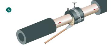
Beide Rohrträgerseiten sowie die Schlauch-Schnittflächen dünn mit Kautschuk-Kleber (Hersteller-geprüft) bestreichen und nach Ablüften zusammenkleben ...
