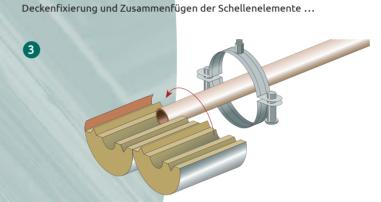
ISOGLOBAL Rohrträger MW um das Rohr fixieren ...
