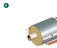
Überlappende Schutzfolie festkleben. ISOGLOBAL Rohrträger mittig in/unter die Rohrschelle schieben ...
