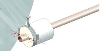
Rohrträger-Naht liegt horizontal auf gleicher Höhe wie Schellenverschraubungen ...
