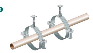
Rohr in die Schellen einlegen und positionieren ...
