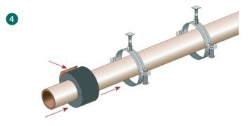
Überlappende Schutzfolie festkleben. ISOGLOBAL Rohrträger mittig in/unter die Rohrschelle schieben ...
